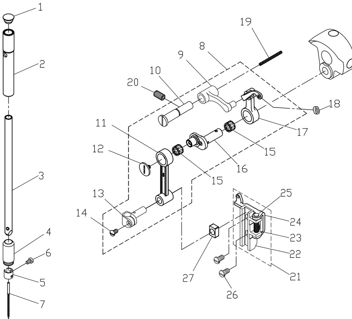
C. CS-5150-BT 針棒·天秤關係 NEEDLE BAR & THREAD TAKE-UP LEVER COMPONENTS
